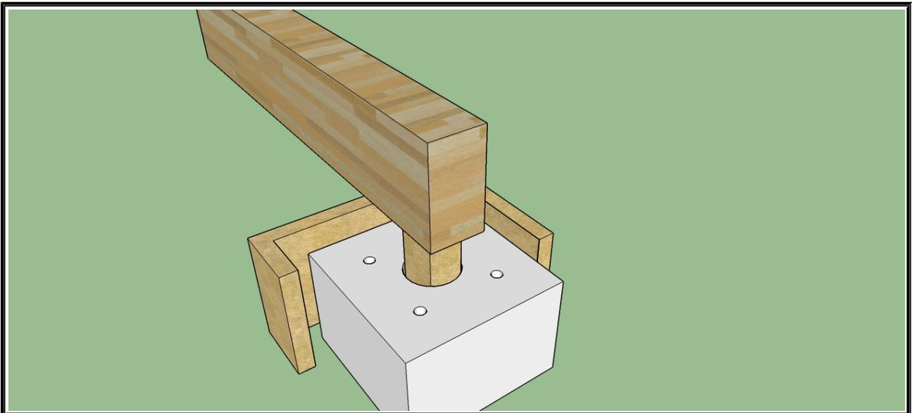
Fase N.4 Collocamento trave, attraverso l' inserimento perno in legno in foro centrale blocco. Si effettuerà per solidarizzare un getto idoneo d' ancoraggio affogando in perno legno nel blocco.
